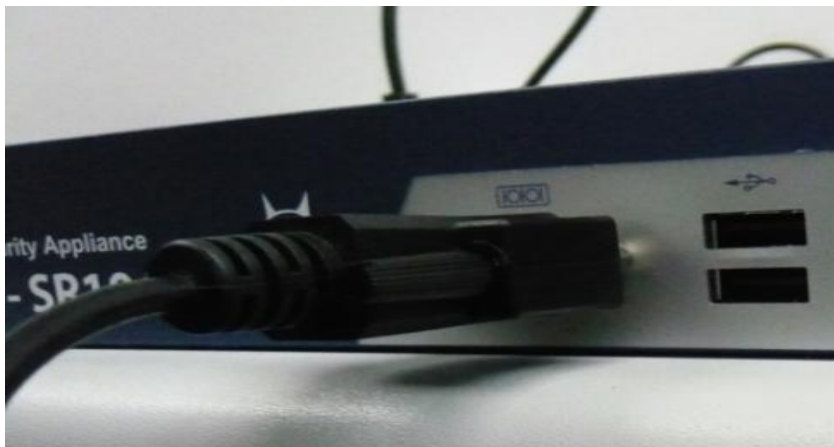
รูปที่ 2.2 แสดงการเชื่อมต่อพอร์ตคอนโซลของตัวอุปกรณ์
